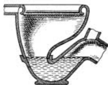
Abb. 246. „Hopper“-Klosett. Verbesserte Form.
